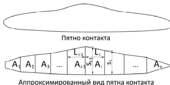
Рис. 6. Схема к определению площади контактной поверхности
